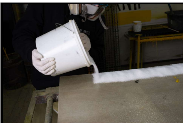
Wykonanie powłoki z korundu na płycie antypoślizgowej
